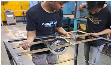
Gambar 4.7 Proses Pemasangan Motor
