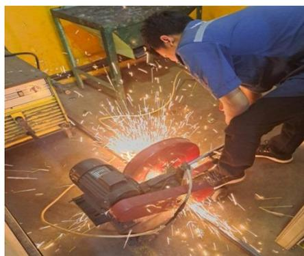
Gambar 4.4 Pemotongan Besi
