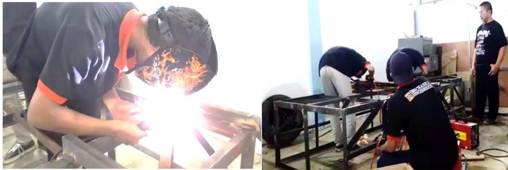
Gambar 10. Proses Penyambungan Besi Menggunakan Las
