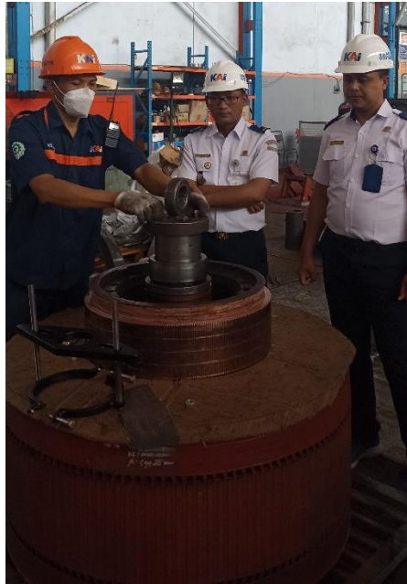
Gambar 12 Pemasangan Alat Pencekam Bearing
