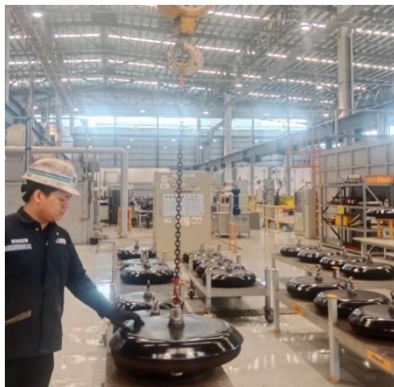
Gambar 1. Proses pemindahan air spring
