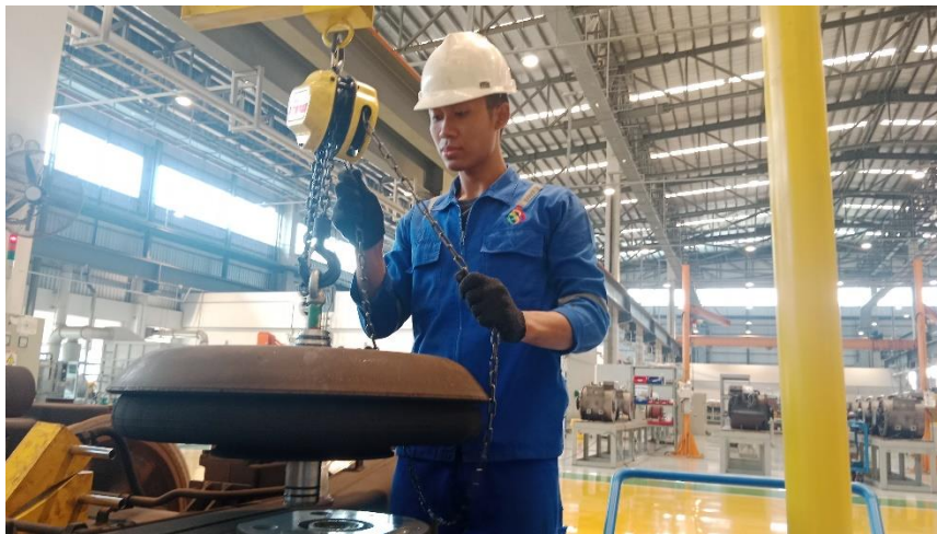
Gambar 11. Pelepasan air spring menggunakan alat crane trolley jig air spring
