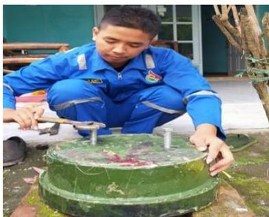
Gambar 7. Pelepasan *molding*
