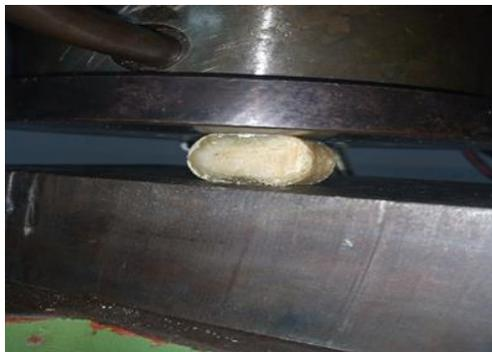
Gambar 13. Pengujian kekuatan tarik diametral
