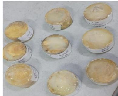
Gambar 11. Spesimen untuk uji kekuatan tarik diametral
