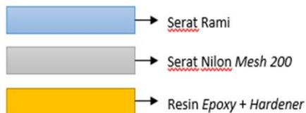
Gambar 2. Ilustrasi susunan laminasi roda komposit hibrid nilon-rami-epoxy
