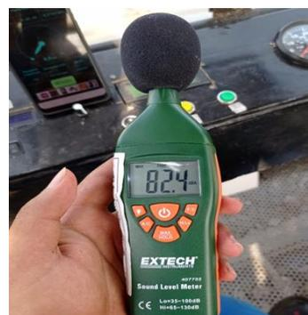
Gambar 22. Pengukuran tingkat kebisingan lori inspeksi saat beroperasi dengan roda hibrid komposit
