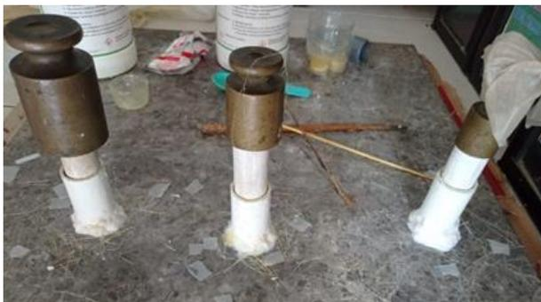
Gambar 10. Pencetakan spesimen hibrid komposit dengan metode *hand lay-up* dan metode *press mold* (beban 250gr, 500gr, dan 1Kg)
