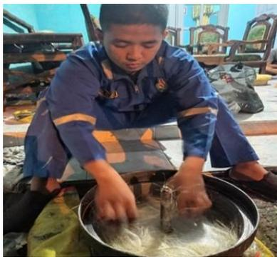
Gambar 6. Penuangan resin dan bahan penguat kedalam cetakan
