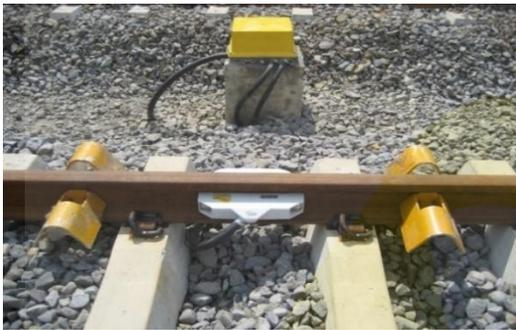
Gambar 5 Pendeteksi gandar (*wheel detector*)
