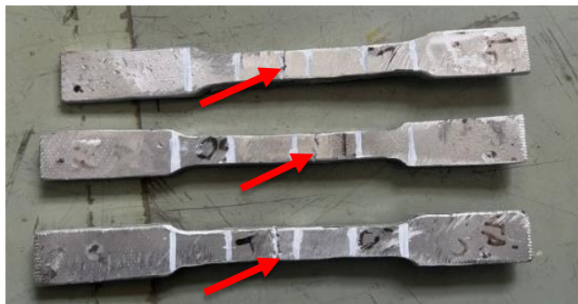
Gambar 7. Spesimen Temperatur 150-200°C setelah Tensile Test
