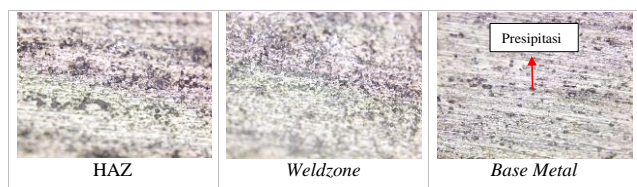
Gambar 4. Struktur Mikro Temperatur 200-250°C
