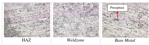
Gambar 3. Struktur Mikro Temperatur 150-200°C
