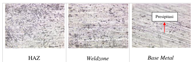
Gambar 2. Struktur Mikro Temperatur 100-150°C
